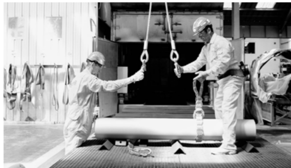
Erhitztes Rohr vor dem Auftragen der Epoxidpulverbeschichtung
